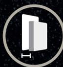
Quando instalado em paredes, é necessário um distanciamento de 50 mm entre o painel e a parede
